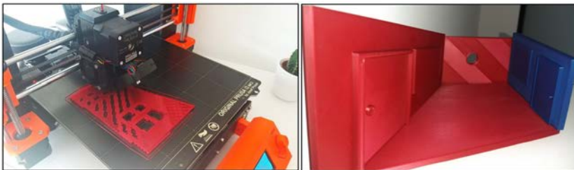
Fig. 10: stampa e assemblaggio dei componenti della stanza di Ames
